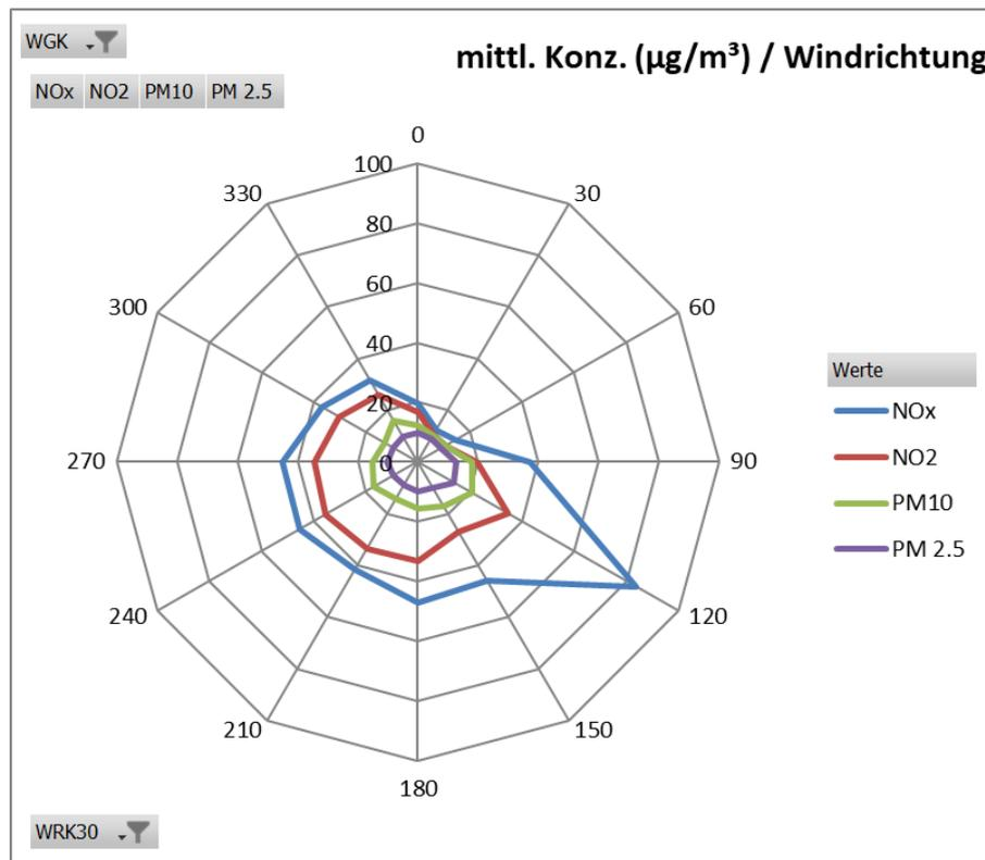
Abbildung 11 Windrichtungsabhängigkeit der Immissionsbelastung im Monat Februar 2023 (es sind nur Datensätze mit Windgeschwindigkeiten > 0,5 m/s in der Darstellung berücksichtigt)
