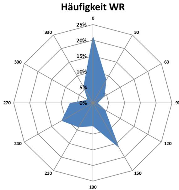
Abbildung 9 Windrichtungsverteilung im Monat Februar 2023 (nur HMW mit Windgeschwindigkeiten > 0,5 m/s)
