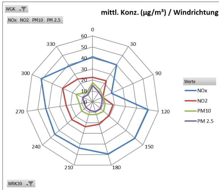
Abbildung 11 Windrichtungsabhängigkeit der Immissionsbelastung im Monat November 2022 (es sind nur Datensätze mit Windgeschwindigkeiten > 0,5 m/s in der Darstellung berücksichtigt)
