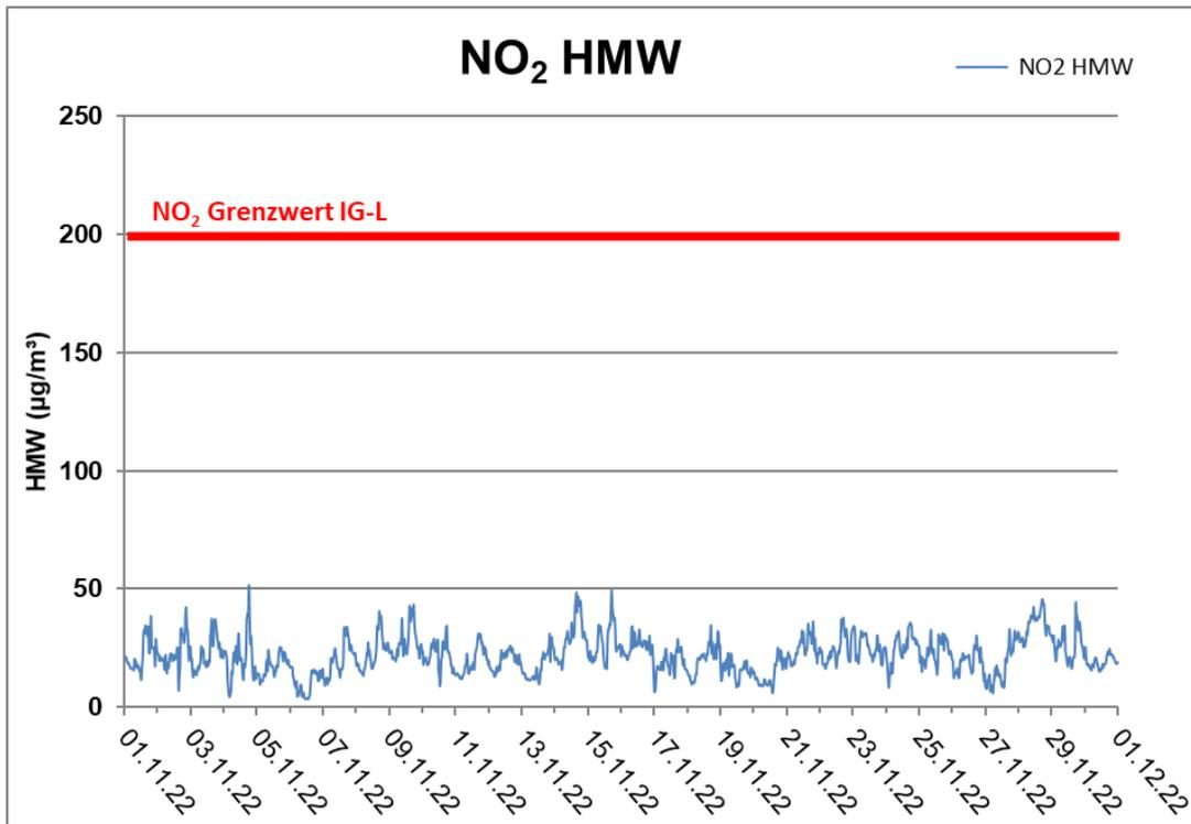
Abbildung 2 Zeitlicher Verlauf der NO<sub>2</sub> Halbstundenmittelwerte der Beweissicherungsmessstelle Angath
