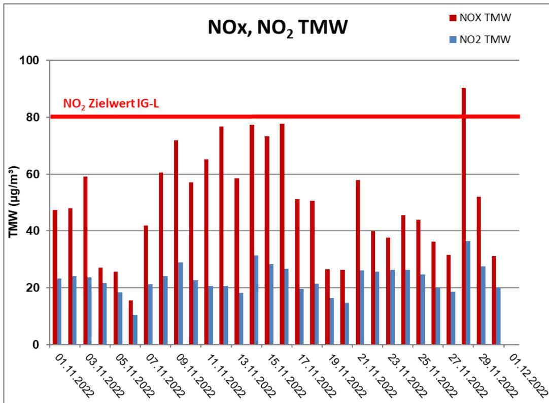
Abbildung 4 Zeitlicher Verlauf der NO<sub>2</sub>- und NO<sub>x</sub>-Tagesmittelwerte an der Beweissicherungsmesstelle Angath
