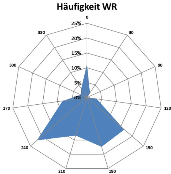
Abbildung 9 Windrichtungsverteilung im Monat November 2022 (nur HMW mit Windgeschwindigkeiten > 0,5 m/s)
