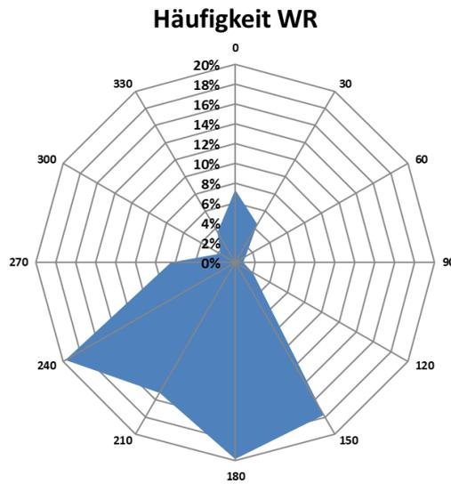
Abbildung 9 Windrichtungsverteilung im Monat Oktober 2022 (nur HMW mit Windgeschwindigkeiten > 0,5 m/s)
