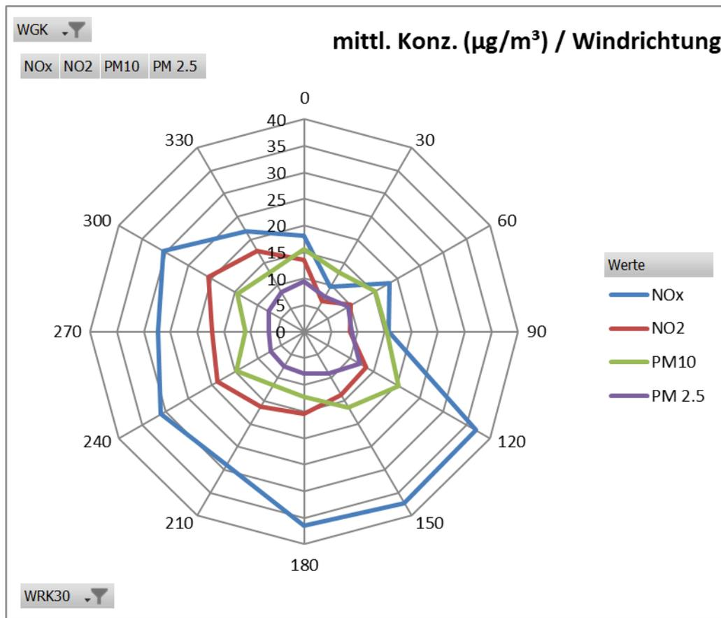
Abbildung 11 Windrichtungsabhängigkeit der Immissionsbelastung im Monat Oktober 2022 (es sind nur Datensätze mit Windgeschwindigkeiten > 0,5 m/s in der Darstellung berücksichtigt)
