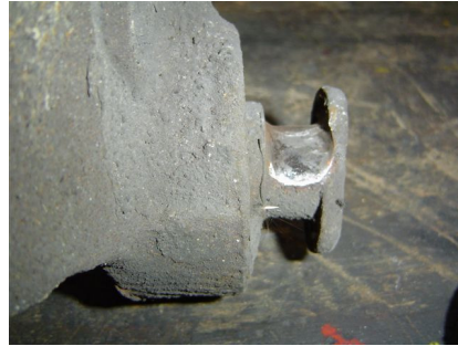
Bild 4 (unzulässige Abnutzung Drehgestell):
