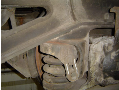
Bild 3 (Manganplatten am Lagergehäuse):
