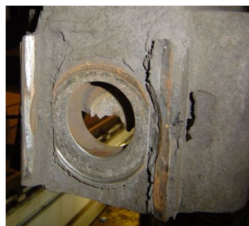
Bild 4 (unzulässige Abnutzung Drehgestell):
