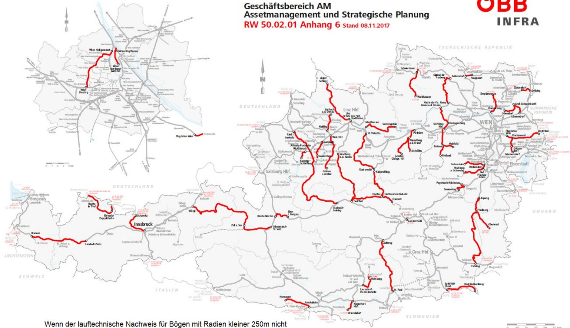
Wenn der lauftechnische Nachweis für Bögen mit Radien kleiner 250m nicht geführt oder nicht erfolgreich absolviert wird, so ist die Netzkonformität für das Befahren **der rot gekennzeichneten Abschnitte** nicht gegeben.
