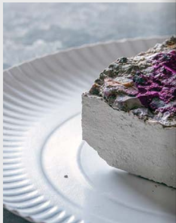
BESTIMMUNG der Karbonatisierungstiefe bei Beton mit alkalisiertem Bereich und verfärbt sich magentafarben
