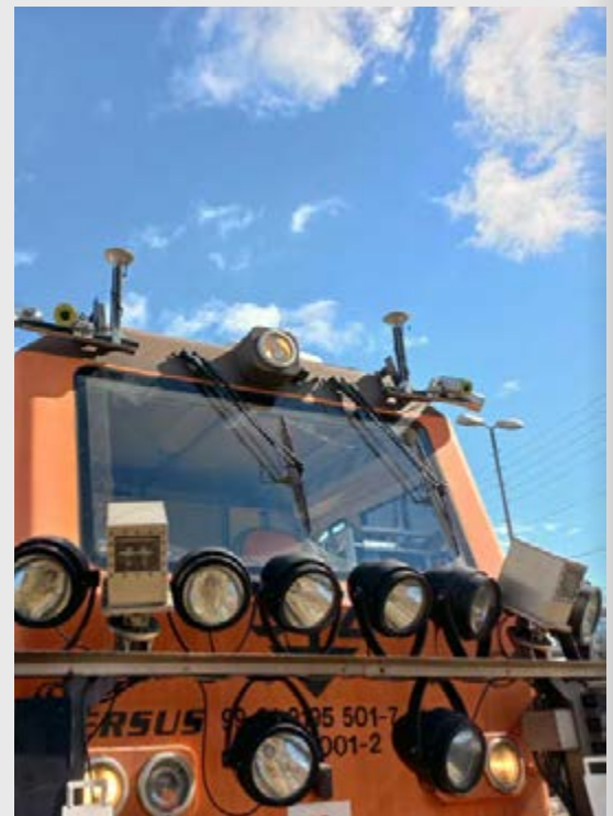
VIER HIGH-PERFORMANCE-KAMERAS am Zug erfassen auch bei hoher Fahrgeschwindigkeit feine Pflanzen
