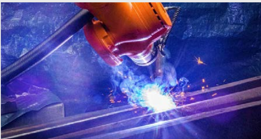
NEUARTIG. Prototyp des Auftragsschweißroboters
