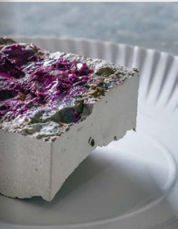
Phenolphthalein – der Farbstoff reagiert mit dem nicht Smart Minerals GmbH
