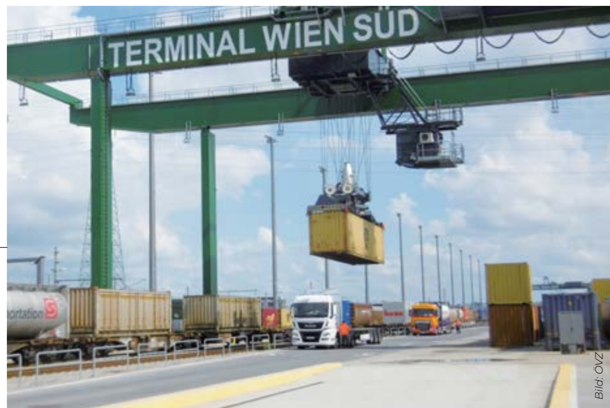
Die Portalkrane am ÖBB Terminal Wien Süd sind 270 Tonnen schwer und können Hübe bis 41 Tonnen bewältigen.
